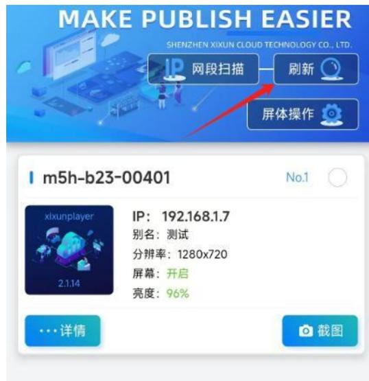
如果无法搜索到控制卡 IP，点击左上角的 IP 搜索按钮，输入 IP 192.168.43. 然后点击“分段扫描”，等待一会后会找到一个 IP 地址，然后点击关闭并再次点击搜索按钮，将会看到控制卡 IP。如图所示：
